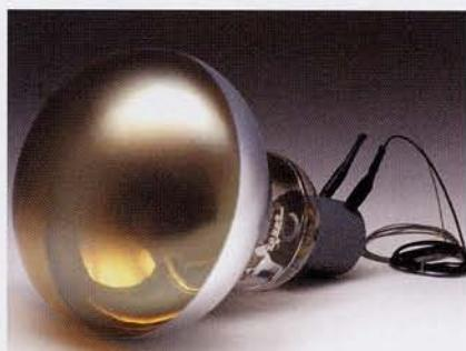
カミオカンデのために開発された直径約50cmの光電子増倍管。このときまでは直径20cmが世界最大だった。
