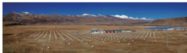
図1：チベット高山（標高4,300メートル）に設置されているチベット空気シャワーアレイ。格子状に白く見えるのが0.5平米のシンチレーション検出器で、空気シャワー中の二次粒子を観測し、宇宙線の到来方向とエネルギーを決定する。
