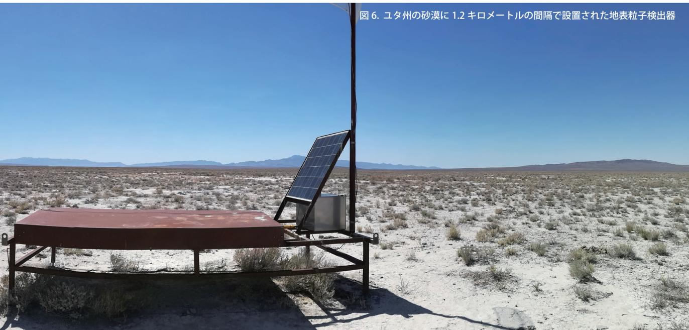
図 6. ユタ州の砂漠に 1.2 キロメートルの間隔で設置された地表粒子検出器
