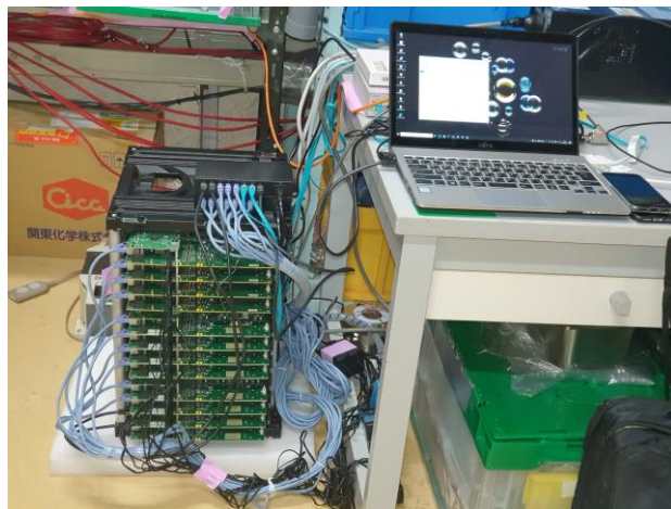
図 1：実験室 D に設置したソフトエラーモニタリング実験装置。放射線耐性の高い SRAM デバイスと通常の SRAM デバイスが用いられている。今後、本装置を用いたソフトエラー発生率測定を行う。
