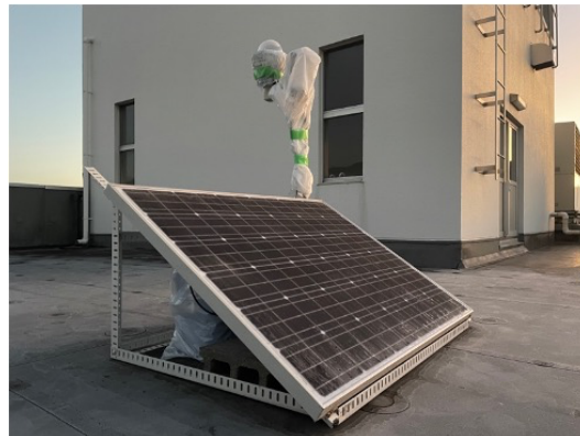
図2 ソーラーパネルを用いた電源自立のための動作試験。信州大学屋上にて実施した。
