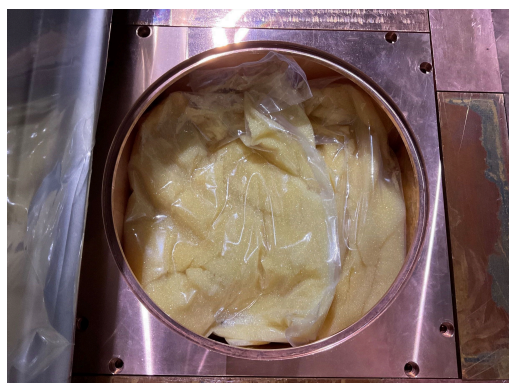
図 1：スーパーカミオカンデ純水装置で用いるイオン交換樹脂を Ge02 検出器で測定中の写真
