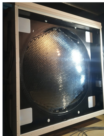
図2 : 組上げ完了した CTA-LST 望遠鏡 2 号機カメラ。
