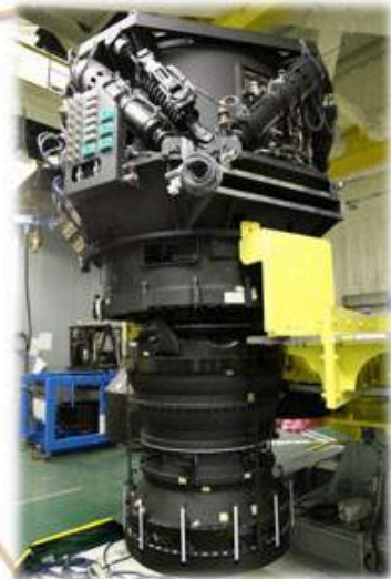
Hyper Suprime-Cam (高さ約3m、重さ約3トン)
