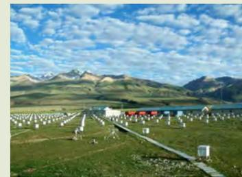
地表の空気シャワー検出器で初めてガンマ線源の観測に成功したチベット空気シャワー観測装置。宇宙線研究所と中国が共同で開発し、1989年、標高4,300メートルにあるチベット自治区ヤンパーチンに建設。空気シャワー最大発達の高度を利用して最先端の観測を繰り返しています。
