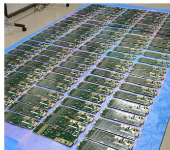
図 3 : 量産した読み出し回路基板。
