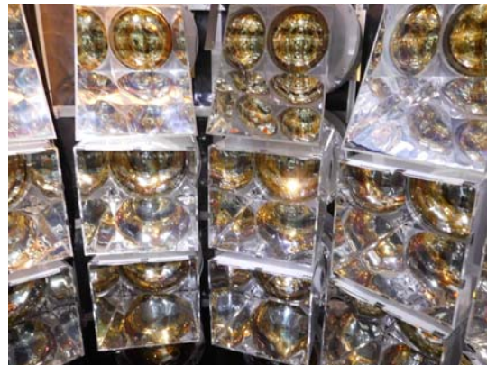
図 3 : CANDLES III システムに導入している光電子増倍管とライトパイプ。写真に写っているのは、3 段分の光電子増倍管。光電子増倍管の丸い光電面が、ライトパイプの内側に映っているのがわかる。最上段の光電子増倍管の光電面径は 10 インチで、2 段目以降は 13 インチ。
