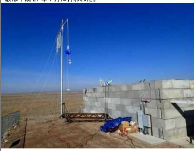
左写真は、ARA 実験の電波検出器をビーム横の高さ 10m の位置に設置した様子である。氷から放射された電波をこれらの検出器で受信しデータを取得した。
