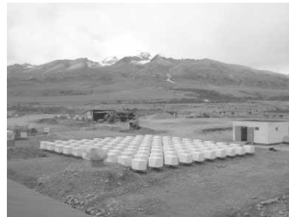
図1 Tibet III アレイの中心に設置した YAC-II アレイ (125 台の検出器から成る)。
