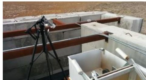
図 2、ビーム射出口をパラボラアンテナは使わずに受信機のみで測定した。加速器を使ったマイクロ波測定実験はいくつかあるが、いずれも電波暗箱の中にビームを打ち込んで測定している。そのためマイクロ波前方放射によるノイズが多くて明確な結果が得られていなかった。本実験では電子ビームを大気中に測定することによりこの問題が会費されている。
