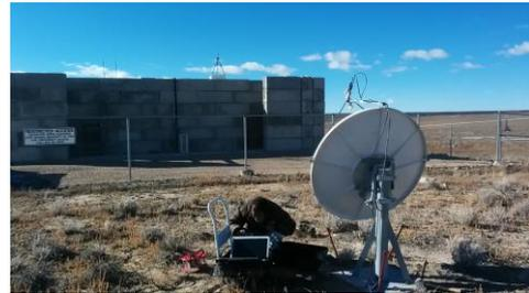
図 1、TA サイトにある線形電子加速器にパラボラアンテナを向け測定を行っているところ。2014 年 11 月に測定した。電子ビームからの等方的な放射は検出されなかった。
