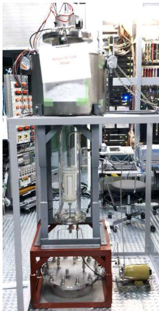
図 2: XMASS サイトに設置した水中ラドン測定装置
