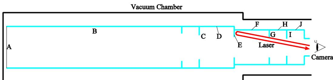
次に、この熱輻射バッフルによる散乱光の伝搬シミュレーションと実測の比較も行った（上図）。今回は、シミュレーションの妥当性を検証する事が目的であるため、使用したレーザー波長は、重力波望遠鏡で使用される1umではなく635nmを利用した。レーザー散乱光を鏡の位置で実際に発生させ、すぐそばに設置した光学カメラ（センサー部露出）で散乱光を受光し、その明るさ情報と、あらかじめ取得していた、カメラの明るさ校正データとの比較から、カメラセンサー部に入射した絶対散乱光量を見積もった。結果、ある特定のバッフルから突出して散乱光が戻ってきている事、センサー部での光量がおおよそ200ppmであることが判明した（下図）。さらに、仮に、この1点で計測された散乱光量がダクト開口部で一様に存在すると仮定すると、その開口全体に帰ってくる散乱光量は、元の光量の2%程度であると見積もることができた。一方、ZEMAXによるシミュレーションは、6%程度であり、オーダーは同じでも、数倍の開きが残った。
