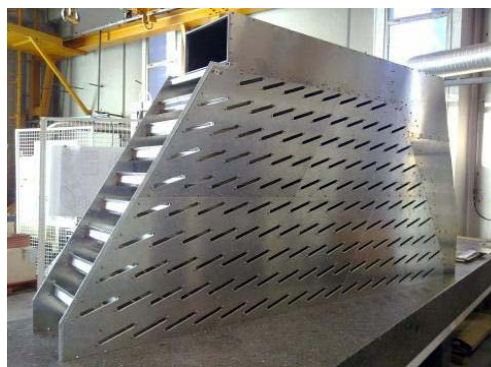
図3、テスト用に製造された PMT クラスタホルダ。1 台のカメラには 7 本の PMT からなる PMT クラスタ 265 個が装着される。この写真はその半分のクラスタを装着する
