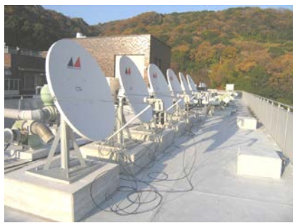
図1. 甲南大学屋上に設置した望遠鏡アレイシステム。12台の1.2m口径パラボラアンテナにBS放送受信用の検出器をとりつけている。全体で4.5度×6度の視野になっている。ここで開発した観測システムをTAサイトに設置して測定を行った。
