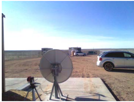
図2. TA サイトに建設されたコンクリートパットの上に設置したパラボラアンテナ。1.2m 口径のパラボラに 12GHz の受信機を取り付けている。この望遠鏡からみて約 90m 前方に ELS が写っている。そこから鉛直上向きに電子ビームが放出される。後方には大気蛍光望遠鏡を格納している建物があり、夜間に観測を行っている。
