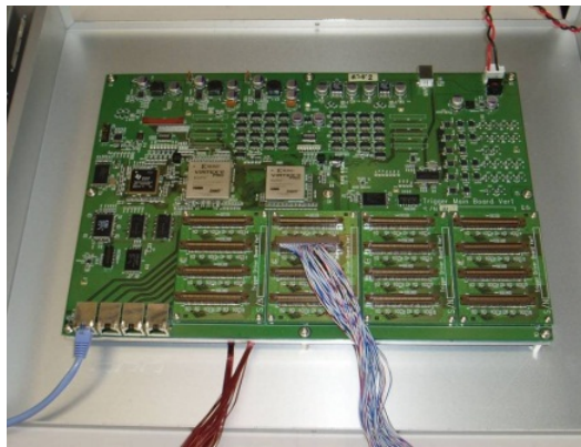
図2 : (左) トリガー回路 (右) CMOS イメージセンサー
