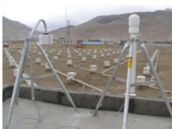
図1 チベット羊八井宇宙線観測所に設置されたフィールドミル電界計(左)と Storm Tracker (右)
