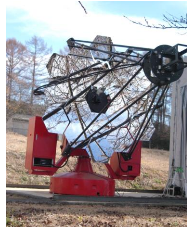
小型鏡光軸調整後の明野小型チェレンコフ望遠鏡反射鏡 (2013 年 12 月)
