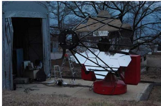
画 R & D の試験台として利用される（発表論文 1）。平成 25 年度は、前年度までに国立天文台岡山天体物理観測所の真空蒸着装置で再蒸着した 18 枚の小型鏡の設置角度を再調整し、Davies-Cotton 光学系としての調整作業を完了した（右上図）。調整後の光学系の集光像をレイトレースシミュレーションの結果と比較し、光学系全体としてほぼ想定通りの集光性能が得られていることを確認した。また、駆動制御系のケーブル長が不足していたため装置の一部が地面に置かれたままとなっていたが、ケーブルを延伸して安全に運用できるようにした。これで整備作業は駆動制御系の較正を残すのみとなり、試験用望遠鏡としての準備は整いつつある。
