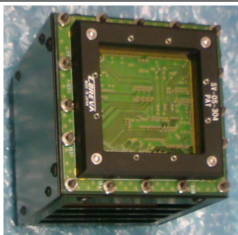
図2 : Ashra-1 CMOSセンサーカメラ
