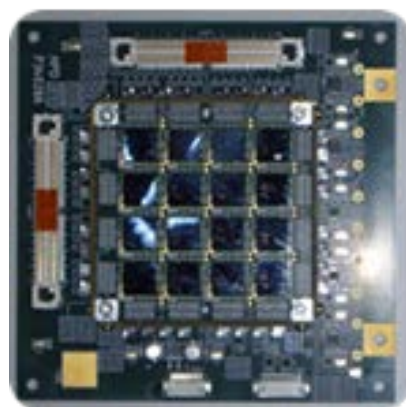
図3 : Ashra-1 トリガーLSI基板
