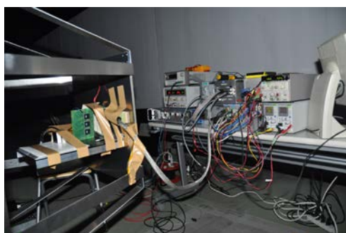
図1: 焦点面検出器の初期統合試験。光学フィルタ、MAPMT、ASICボード、1次、2次トリガボード、制御CPUボード、クロックボード等が接続されている。
