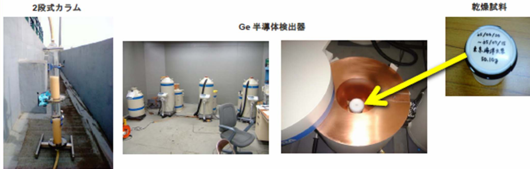
Fig.3. 2 段式カラムによるイオン交換と測定機器
