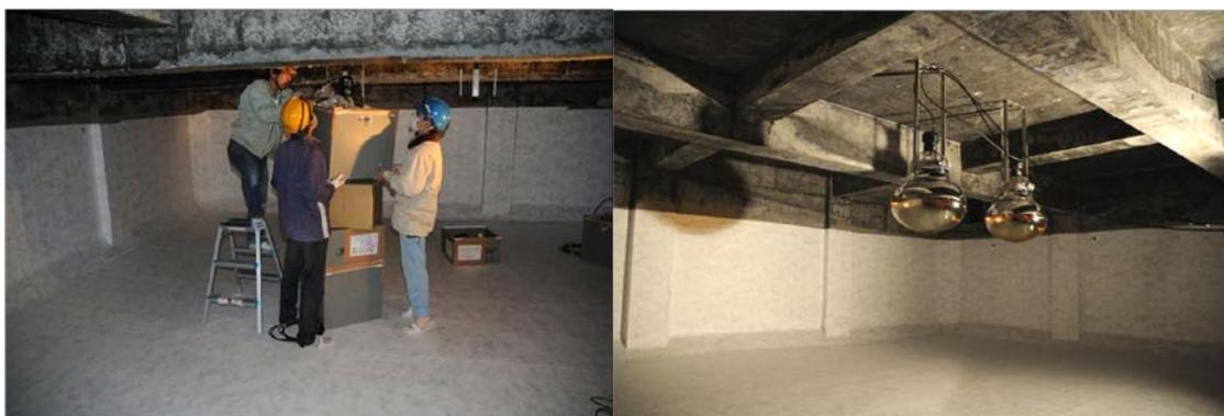
図1 Tibet-MDの水槽内部。左図は光電子増倍管を水槽に装着している場面である。右図は装着した光電子増倍管の様子である。最小ユニット50m<sup>2</sup>に対して2本の光電子増倍管が装着されている。これは、一つには故障時の予備として、また今一つには、アクシデンタルノイズが問題となる場合に2本の光電子増倍管の信号のコインシデンスを取ることによってノイズ除去能力を高めるためである。
