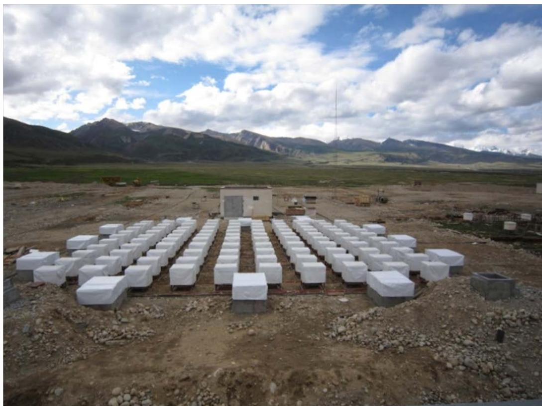
図2 空気シャワーコア観測装置YAC-IIを構成する約100台のバースト検出器。主として陽子成分を選別するように調整されている。
