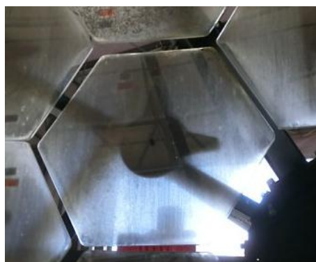
再蒸着前の明野チェレンコフ望遠鏡反射鏡の状態。表面のアルミ膜が劣化し背景からの光が透過している
