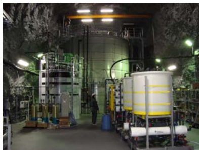
図3: EGADS 装置。中央: 200 トンタンク。左手前: G d 前処理システム。右: 透過率モニター (UDEAL)。
