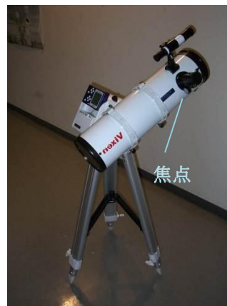
図 1 本測定に使用した直径 130mm のニュートン反射型望遠鏡。焦点面の光をファイバーで分光器に導入する。
