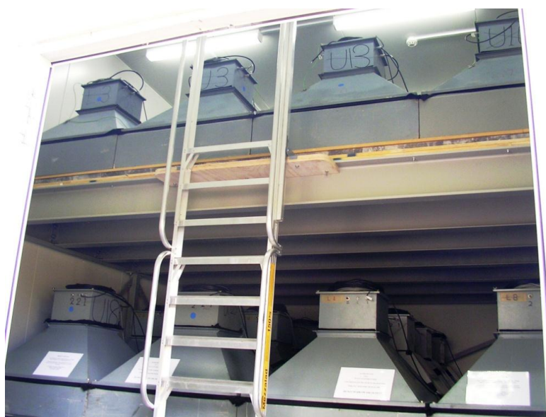
図1. 新設された架台上に設置された新宇宙線計。1 m 2 のプラスチック・シンチレータ検出器が上下2層に各16（4x4）台設置されており、上下層間（上層検出器の下）には厚さ5cmの鉛層が敷かれている。上層の重量を支える梁鋼材が見える。
