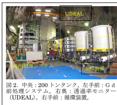
図2. 中央：200トンタンク。左手前：Gd前処理システム。右奥：透過率モニター（UDEAL）。右手前：循環装置。
