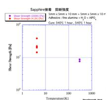
サンプル数が少ないが、300Kに比べて4.2Kでの強度は上 がっている傾向が見られる。4.2Kにおける最大剪断強度は4x10<sup>7</sup> Pa に達しているので、直径250mm長さ150mmのサファイア鏡の重量30kgを支えるために必要な接着面積は7.4mm<sup>2</sup> となる。鏡を2組のU字懸架ロッドで支える場合、1本当たりの接着面積がロッドの断面積とほぼ等しくなるので、強度面では接着による接合は実用レベルにあると考えられる。
