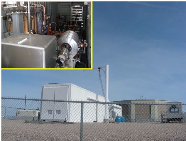
図 1 (左): 望遠鏡ステーションから 100m 前方の地点に設置された小型電子加速器による較正システム。白いコンテナに、加速器本体(左上挿絵にある)が収納されている。
