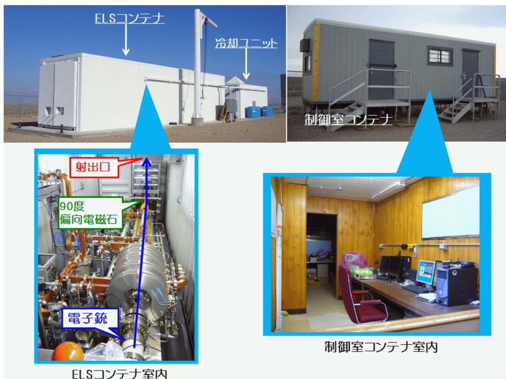
図1: ELSの様子。ELS コンテナ(左)と制御室コンテナ(右)
