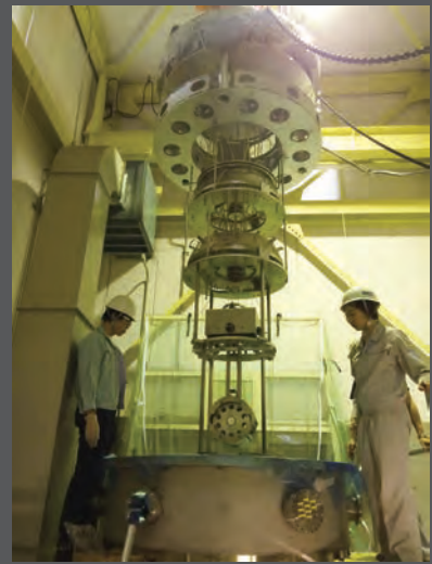
図5上：KAGRAを構築する鏡の一つを地面振動から防振する装置。この写真では、最終端には、本物の鏡を模したアルミの円筒が装着されている。国立天文台内での作業風景。(提供:国立天文台)
