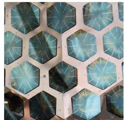
図7：改修後の検出器表面、光電子増倍管周辺の溝がなくなって平面になっている。
