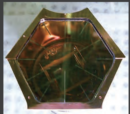
図5：実際にリングが取り付けられた光電子増倍管
