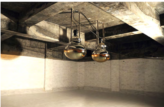
地下に設置されている注水前の水チェレンコフ型ミュオン検出器
