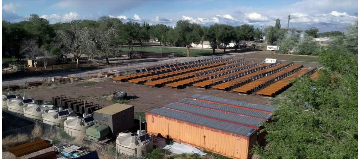
(図6) TA サイトの作業場 (Cosmic Ray Center) にて、ヘリコプターでのユタ荒野への設置を待つ TA×4 用の 180 台の地表粒子検出器。また、TA と Auger の検出器の性能を比較するために、Auger で使われている水チェレンコフ光検出器 6 台 (写真左下) も、設置へ向けた準備が進んでいる。
