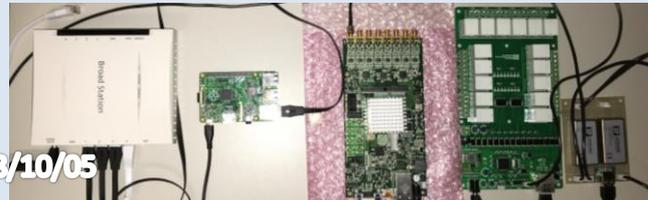
電力自給・自動観測システムについて以下の構成で5分ごとに起動・停止をスケジュールして試験を行った
