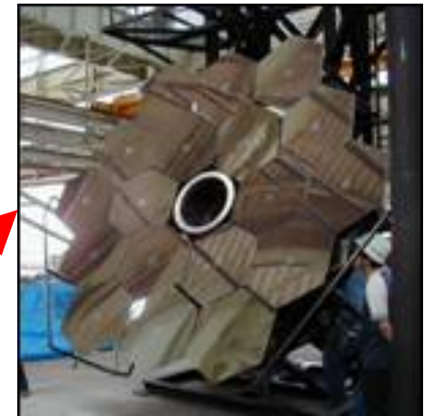
18枚の複合球面鏡 (口径3.3m)
