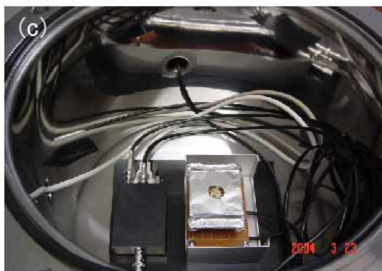
図12 : (a) ペルチェにマウントした新プロトタイプInP SI検出器 (b) 放熱板にマウントした検出器 (c) 真空チェンバーに入れた検出器 (d) 真空ポンプに接続した冷却システム全体
