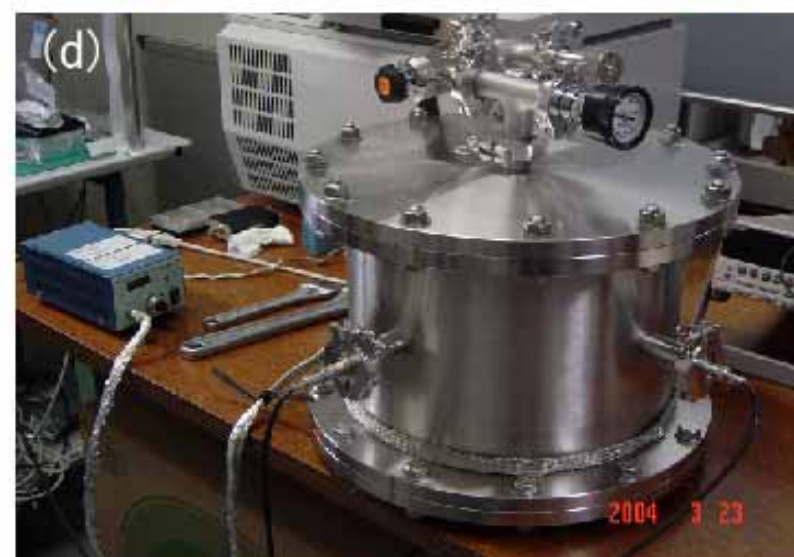
図12 : (a) ペルチェにマウントした新プロトタイプInP SI検出器 (b) 放熱板にマウントした検出器 (c) 真空チェンバーに入れた検出器 (d) 真空ポンプに接続した冷却システム全体
