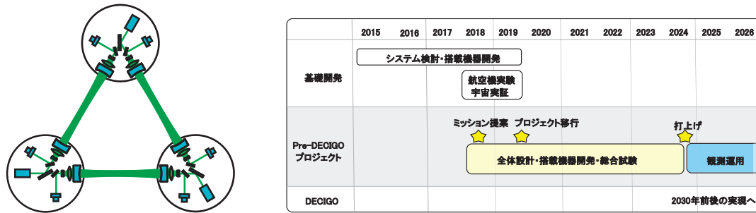
図 6: (左) Pre-DECIGO の概念図. 約 100 km 離れた 3 機の宇宙機でフォーメーションフライトを行い, 長基線のレーザー干渉計を構成する. (右) Pre-DECIGO 実現までのスケジュール.
