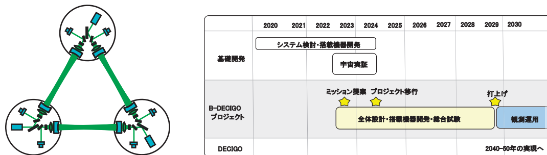
図 10 (左) B-DECIGO の概念図。約 100 km 離れた 3 機の宇宙機でフォーメーションフライトを行い、長基線のレーザー干渉計を構成する。(右) B-DECIGO 実現までのスケジュール。
