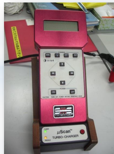
可搬式反射率・表面 粗さ測定器 \mu SCAN (Schmitt measurement 社製, OAO保有)
