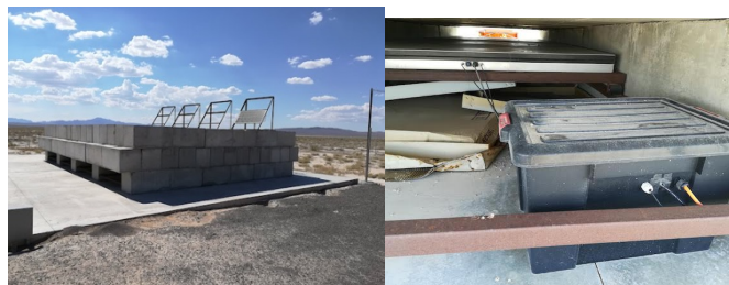
図：(左) コンクリートシールドされたシンチレーション検出器とそのエレクトロニクス設置場所 (下) TA-Auger 同時イベントにおける信号の相関。
