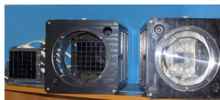
図 2 第 2 世代焦点面検出器の写真。左： アップグレードした EUSO-TA 用焦点面検出器、中： mini-EUSO 用焦点面検出器、右： 比較用 検出器とダミーレンズ。
