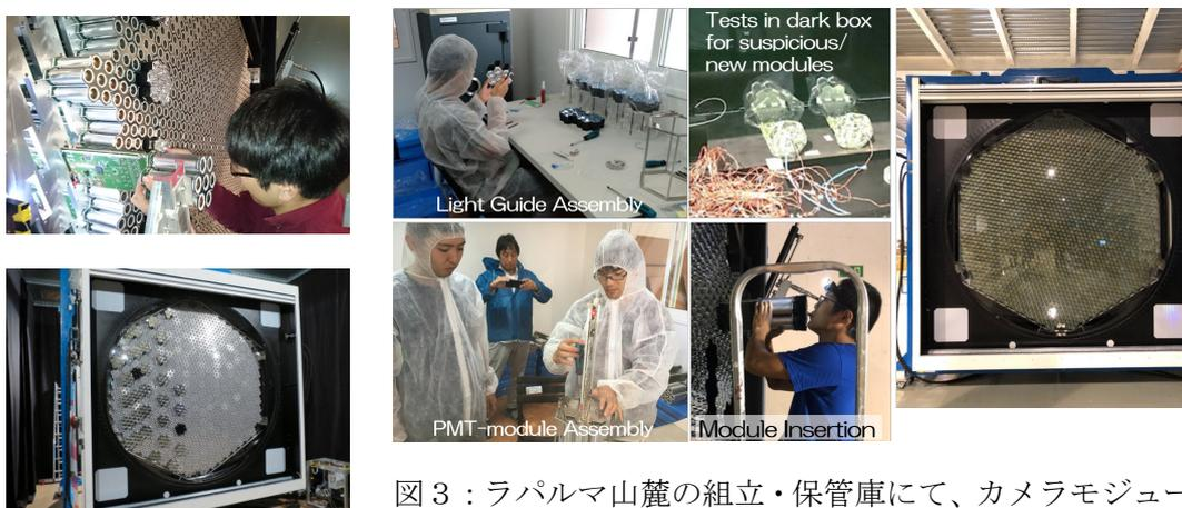
図3：ラパルマ山麓の組立・保管庫にて、カメラモジュールの組立て・試験、筐体への取り付け作業、および、完成したカメラ。
