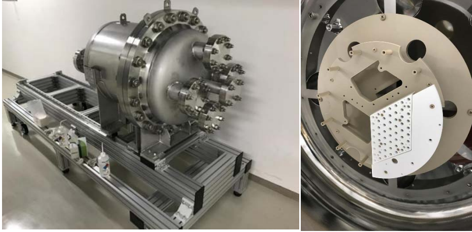
図 1. 180 リットル検出器の容器（左）、1 枚目の ELCC ユニットを取り付けた様子（右）
