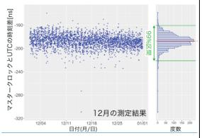
図 2:KAGRA の基準時間は UTC に対して 平均 187ns 遅れるが、重力波到着時刻の確 定に対し十分な精度を持っている。
