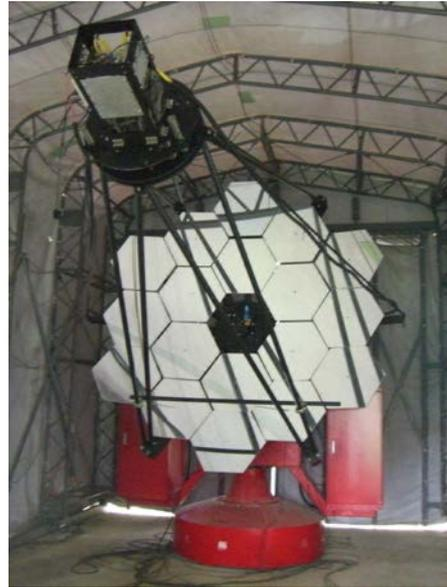
明野望遠鏡で行っている R & D の一つが、本研究代表者他が科研費で開発した低消費電力データ収集システムである。平成 25 年度に明野望遠鏡に導入されたこのシステムは、焦点面カメラを構成する 32 画素（光電子増倍管）で受信した大気チェレンコフ光波形を、わずか 4 つのアナログメモリ ASIC で高速サンプル（1 GHz）し、デジタルデータとして記録する。平成 28 年度にこのシステムで大気チェレンコフ光の初観測に成功した後、平成 29 年度には TeV ガンマ線領域の標準天体であるかに星雲の観測を実施した。一週間程度の観測シフトを 2 回行い、合計で 10 時間弱のかに星雲の観測データと、ほぼ同量の OFF 観測データ（バックグラウンド事象量を見積もるためのブランクデータ）を蓄積した。次年度にこれらの解析を行い、かに星雲からのガンマ線信号の検出を試みる。
